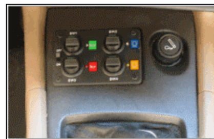
Exemple d'encastrement : BCSE dans l'emplacement du cendrier
